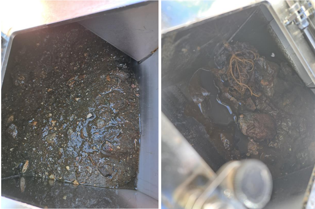
Figur 3.3. Venstre: Bilde av grabbprøve fra stasjon F4 hvor fraværet av erosjonssikringsmasser (pukk) tyder på at prøven er tatt utenfor tildekkingsområdet. Venstre: bilde av grabbprøve fra tildekket område og med erosjonssikringsmasser.
